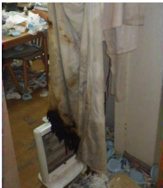
電気ストーブに洗濯物が接触し、損傷した状況
