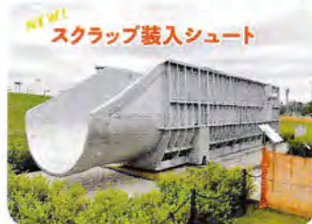
1995年まで第1製鋼工場転炉内に最大20トンのスクラップを装入するために使用されていたシュート
