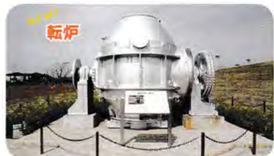
製鋼工場で作る転炉の実験用として2006年までスチール研究所で使用していた実験炉(5トン)を設置
